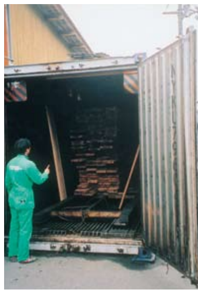
冷凍コンテナを改造した木材乾燥機
